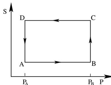
Abbildung 1: Brayton-Joule-Zyklus im  $S$ - $P$ -Diagramm
